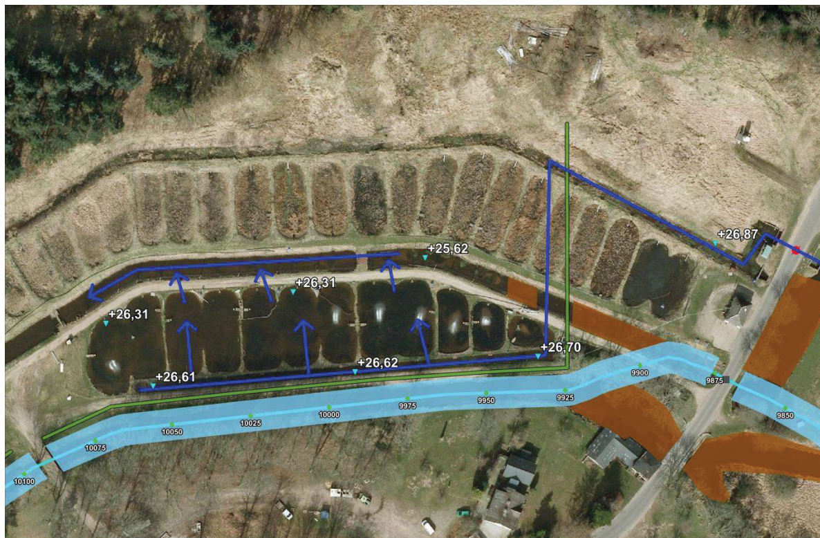
Figur 36 Ny indløbskanal vest for Drivervej. Åbning af tidligere fødekanal mod nord, der forbindes med den igangværende fødekanal mod syd.
