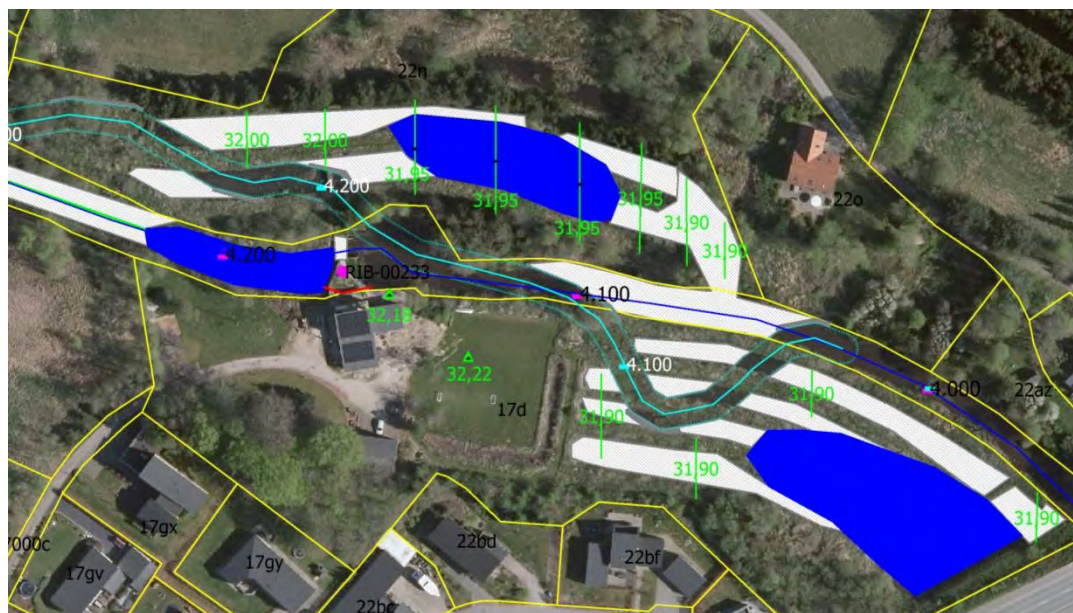
Figur 13. Udsnit af projektforslag samt terrænhældning nord og øst for Præstevænget 24, hvor terrænkoter er angivet med grøn. Omlægning af Vejen Å (lyseblå streg med skråningsanlæg),stensikring (rødbrun), etablering af søer (blå), vandindtag (grøn) og afløb (rød), jordopfyldning (grå), etablering af spang (brun), matrikelskel (gul).
