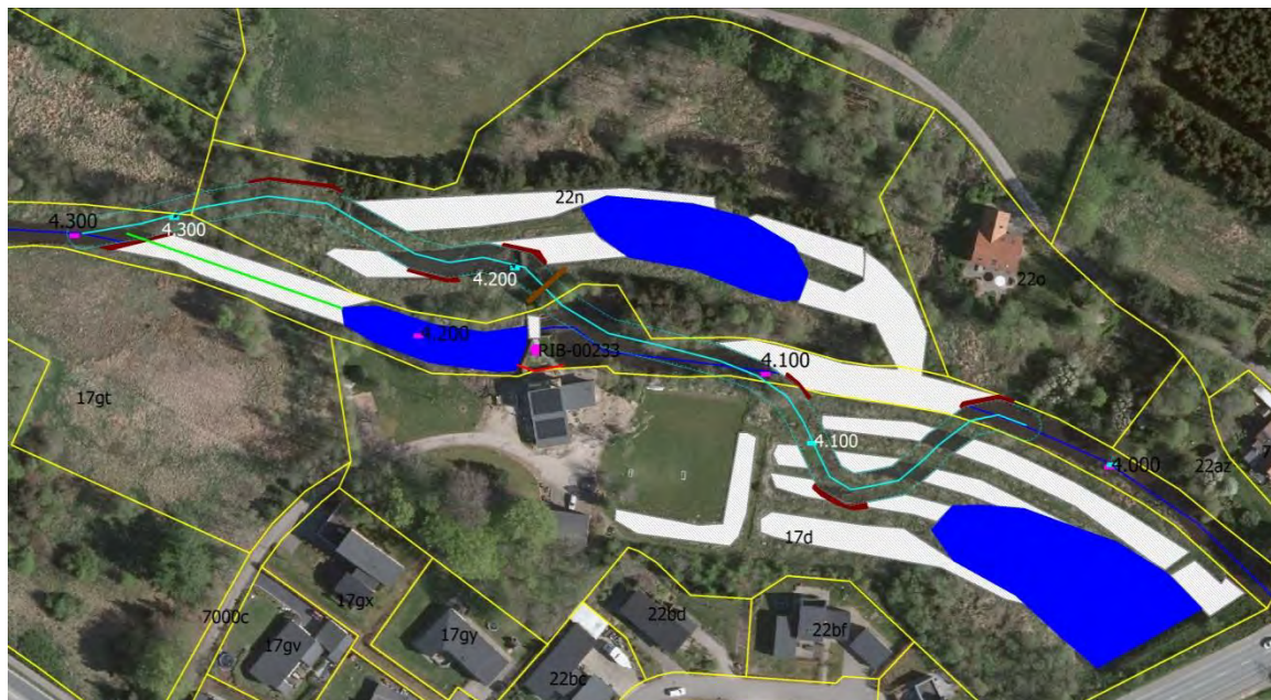
Figur 9. Projektforslag for etablering af faunapassage ved Vejen Lille Vandmølle, spærring RIB-00233. Vejen Å omlægges (lyseblå streg med skråningsanlæg) mod nord igennem de vestligste damme opstrøms opstemningen, hvorefter det trækkes tilbage i det oprindelige forløb nedstrøms opstemningen. Ydersiden af flere sving stensikres (rødbrun). Der etableres tre søer (blå) i projektområdet, hvoraf den ene er skitseret med vandindtag (grøn) og afløb (rød). Af kortet ses desuden områder til jordopfyldning (grå), etablering af et spang (brun) og matrikelskel (gul) Projektforslag fremgår desuden af bilag 2.
