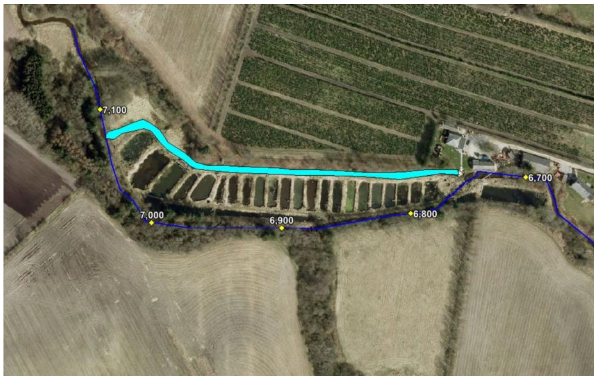
Figur 23 Et midlertidigt sandfang etableres i dambrugets fødekanal (markeret med turkis)
