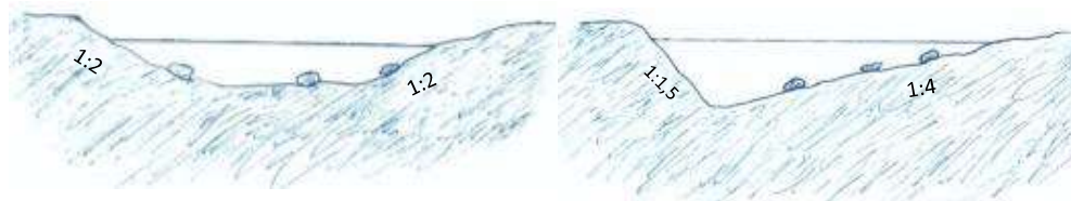
Figur 17. Principskitse for vandløbsprofilen for lige strækninger af det nye forløb. Anlægget kan variere i forhold til det angivne på kortet.
