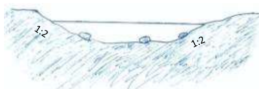
Figur 11. Principskitse for vandløbsprofilen på lige strækninger af det nye forløb. Anlægget kan variere i forhold til det angivne på kortet.
