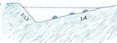
Figur 12. Principskitse for svingprofil af det nye forløb. Anlægget kan variere i forhold til det angivne på kortet.
